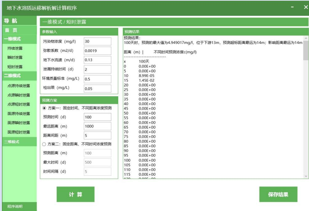
图 7.4-2 事故发生后 100d 后预测结果截图（氨氮）
