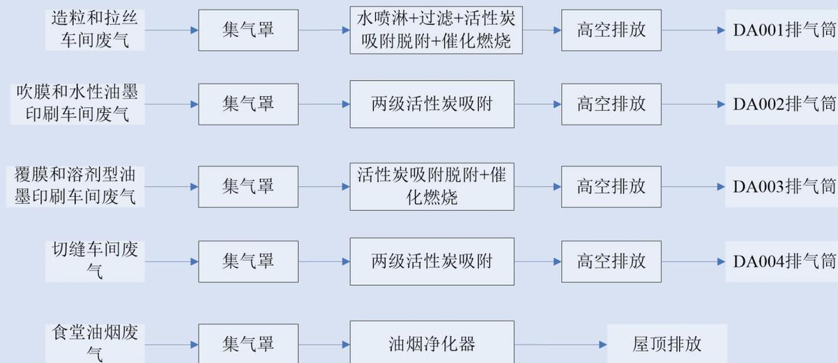
图 9.2-1 项目废气处理设施工艺图
