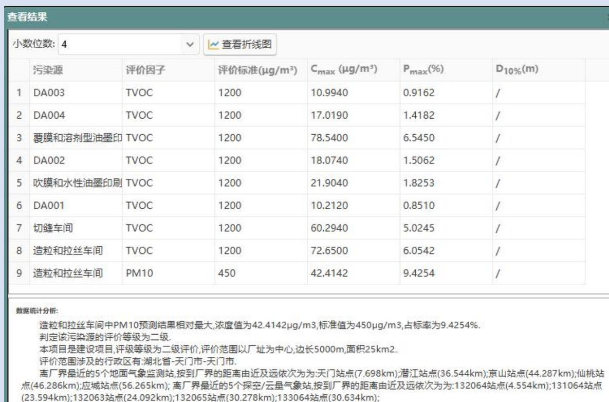
图 2.7-1 大气估算模型 AERSCREEN 计算结果
