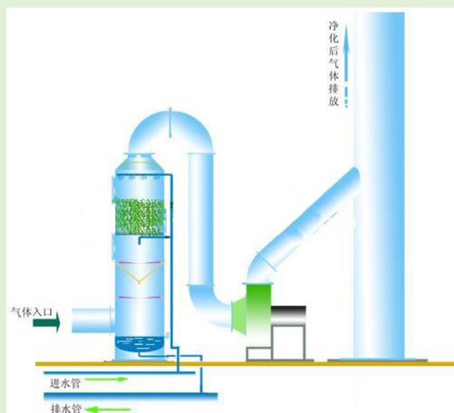
图 8.1-2 碱吸收塔废气处理工艺流程图
